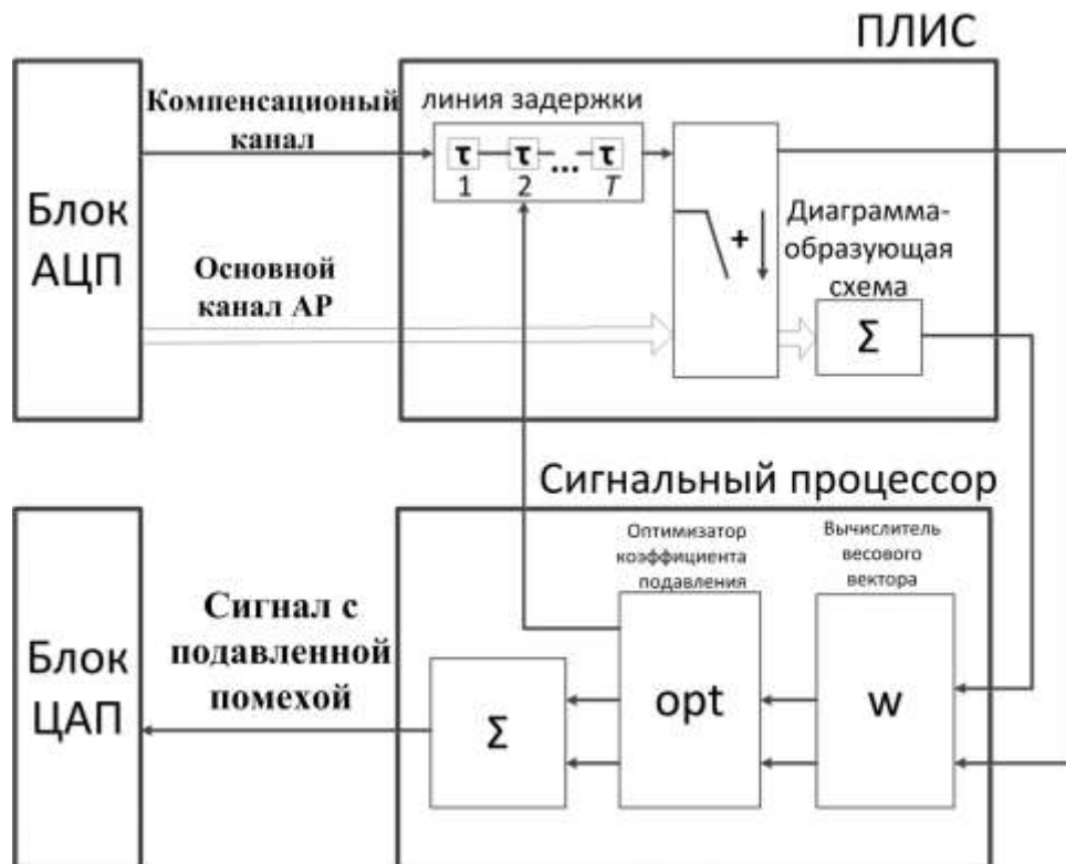
Рис. 2.45. Структурная схема блока вычислений
