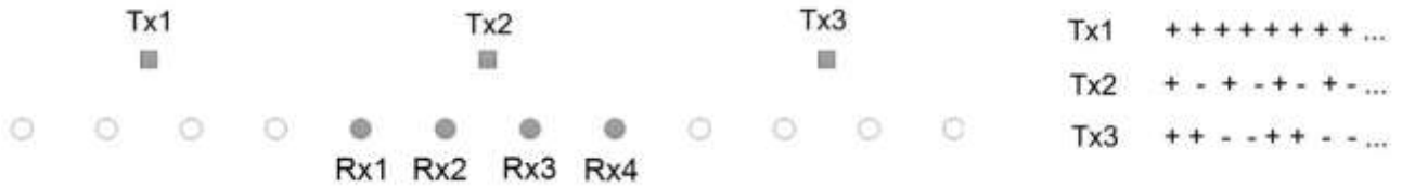
Рис. 4.3. Топология MIMO радара
