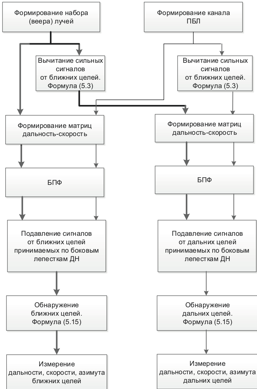
Рис. 5.2. Блок-схема первого алгоритма
