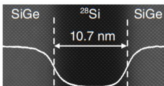
Рисунок 1. Изображение гетероструктуры ^{28}\text{Si}/\text{SiGe} , используемой при создании кубитов [23]
