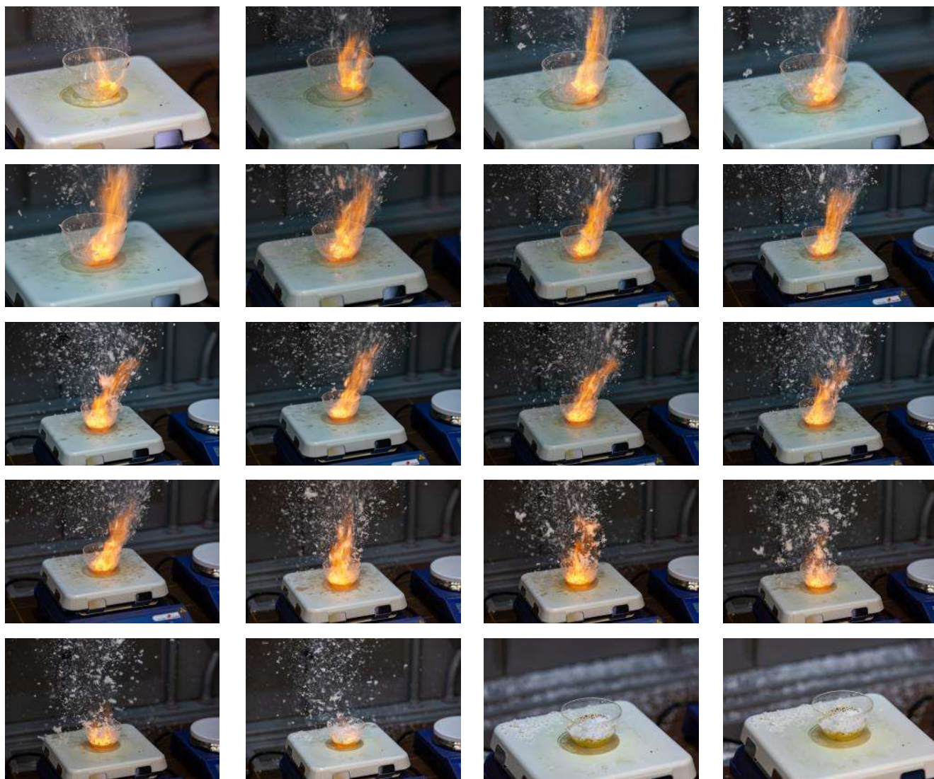
Рисунок 11. Внешний вид реакционной смеси при протекании самораспространяющегося высокотемпературного синтеза оксида иттрия с использованием глицин-нитратного прекурсора
