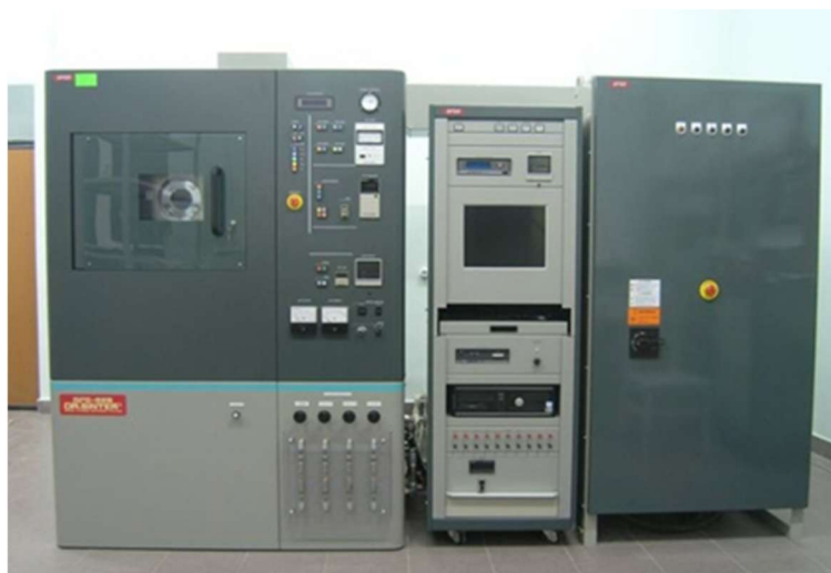
Рисунок 14. Внешний вид установки электроимпульсного плазменного спекания SPS-625
