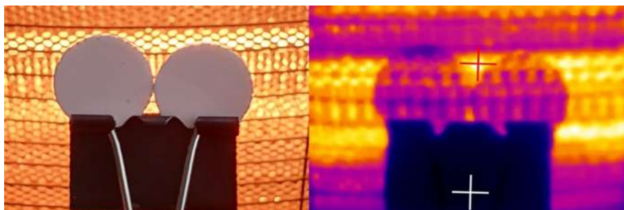
Рисунок 68. Фотография и соответствующее тепловое изображение керамики, после горячего прессования при температуре 1400 °С из недеагломерированных (левый образец) и деагломерированных (правый образец) порошков СВС, на фоне ИК-нагревателя
