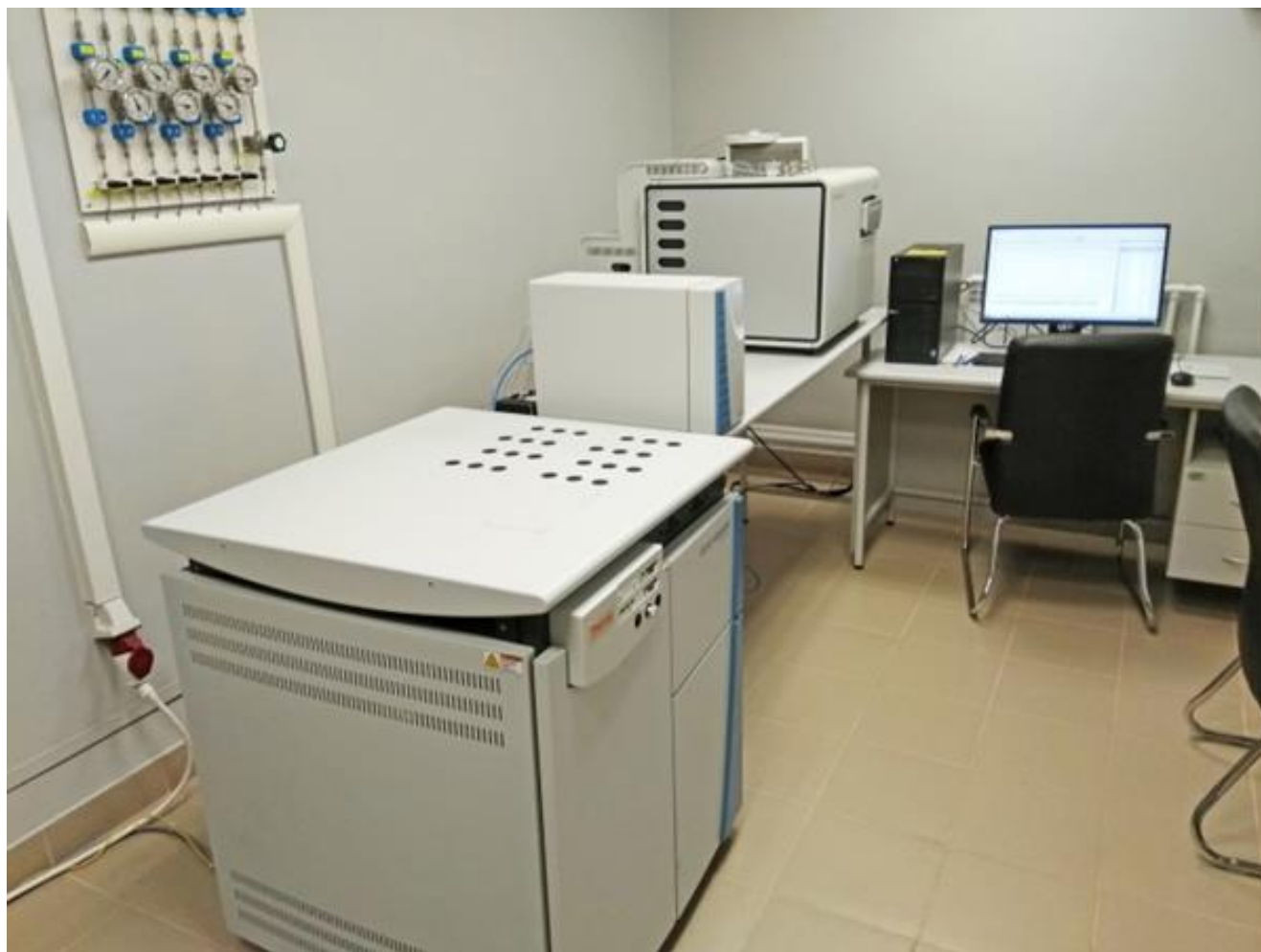
Рисунок 8 – Изотопный масс-спектрометр Thermo Delta V Advantage с газовым интерфейсом ConFlo IV и элементном анализаторе EA Isolink Flash IRMS
