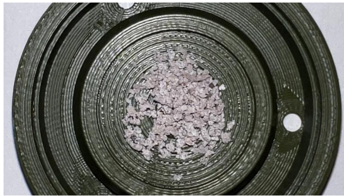
Рисунок 3.74 – Фотография радиоактивного порошка YAG:Nd после отжига при 1000 °С
