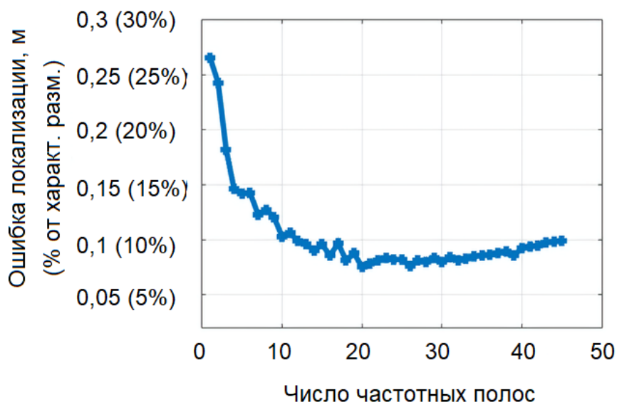
Рис. 1.18. Ошибка локализации в метрах и процентах от характерного размера в зависимости от числа частотных полос, по которым проводится суммирование целевых функций (1.11)
