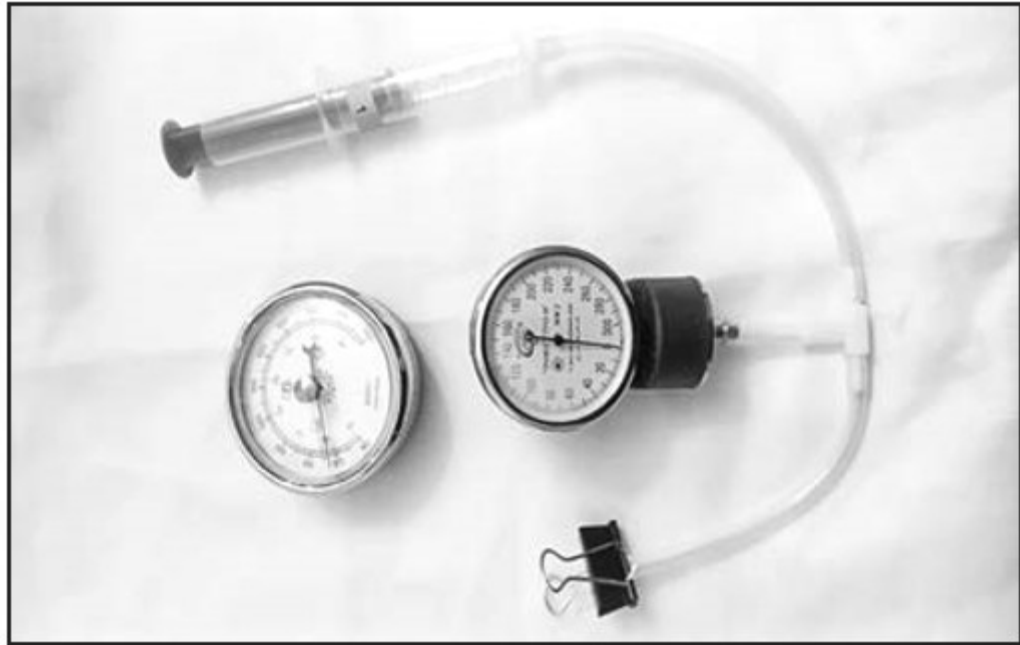
Рисунок 3.1 - Экспериментальная установка для изучения закона Бойля-Мариотта [118]
